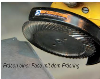
Die Werkzeuge können mit handelsüblichen elektrisch oder pneumatisch betriebenen Handwinkelschleifern mit einer Drehzahl von 12.000 U/min eingesetzt werden und sind in den Durchmessern 70, 116 und 125 mm verfügbar. Metalle wie Aluminium, Titan, Kupfer, Messing und Bronze, sowie Kunststoffe, CFK/GFK und auch Holz können effektiv bearbeitet werden.
